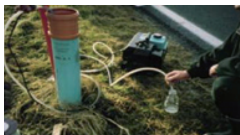
Grundwassermessung mit Piezometer
